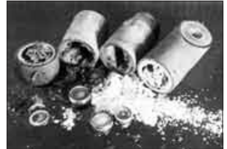
Gehören stark verkalkte und defekte Leitungsrohre bald der Vergangenheit an?
